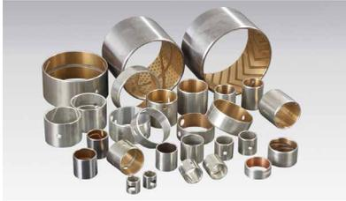
Bimetal-Gleitlager widerstehen schweren Lasten und Stössen. Auf ein Trägerblech wird dazu eine metallische Gleitschicht gesintert. Je nach Anwendung stehen unterschiedliche Bronzelegierungen zur Verfügung. Diese Lager sind nicht wartungsfrei und benötigen eine gute Schmierung.
