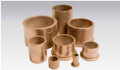
Sinterlager sind selbstschmierende (ölimprägnierte), wartungsfreie Sinterprodukte, die in grossen Serien nach DIN 1850-3 oder ISO 2795 hergestellt werden. Ihre guten Lagereigenschaften werden durch die hohe Fertigungsgenauigkeit und die Porosität des Sinterwerkstoffes nach DIN 30910-3 entscheidend bestimmt.
