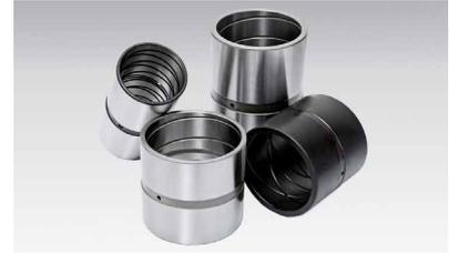
Gehärtete Stahlbuchsen werden bei niedrigen Drehzahlen mit sehr hohen spezifischen Lasten eingesetzt, z.B. bei Bau-, Landwirtschafts- und Erdfördermaschinen, Abbruchwerkzeugen etc.
