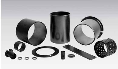
Die Hochleistungsgleitlager besitzen eine höhere Tragfähigkeit ( $<820 \text{ N/mm}^2$ ) und PV-Wert ( $9.6 \text{ N/mm}^2 \times \text{m/s}$ ), Einsatztemperaturen und Gleitgeschwindigkeiten. Dank hoher Korrosionsbeständigkeit und Lebensdauer verfügen sie über eine längere Standzeit.
